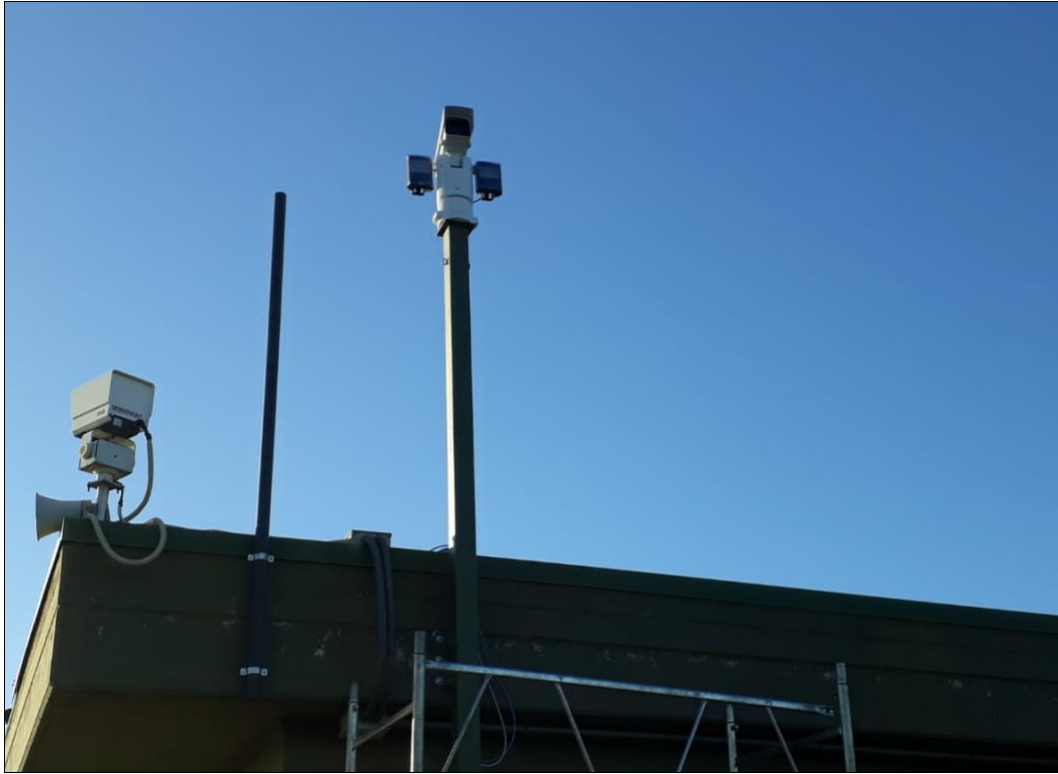
Installazione presso il 4° Stormo Aeronautica Militare di Grosseto di telecamere intelligenti per la bird-detection
